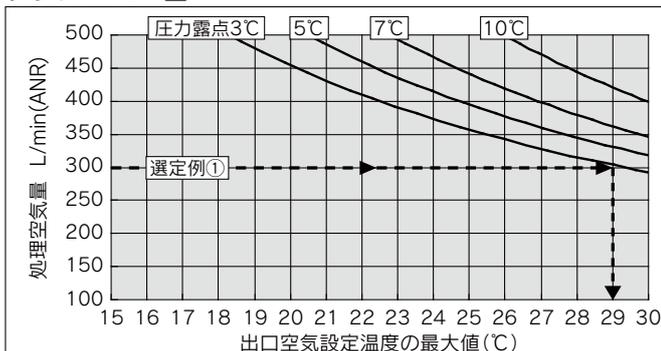
【注意事項】各機種最大の処理空気量 (IDH□4 : 500L/min、IDH□6 : 800L/min) を超えない範囲で選定してください。
